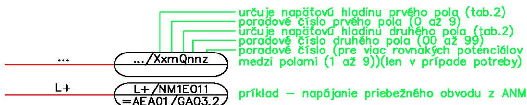
Obrázok 6 Parametre atribútu "LTG" medzi polami VLSP a ostatnými polami
